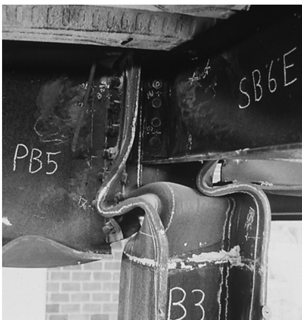
8. Plastische vervorming van het onbeschermde deel van kolom B3 na de raamwerkproef.
