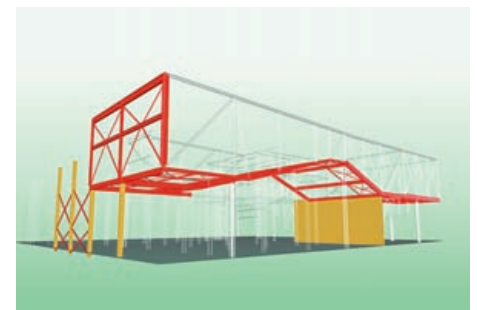
De (geknikte) vloer vormt een windligger en koppelt zo de stalen doos aan de ondergelegen windbok en de betonwand.
