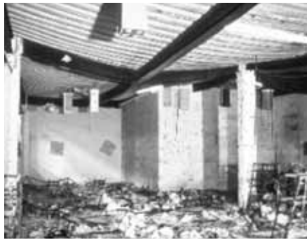
3. Grote Cardington brandproef in een 'echt' kantoor vóór en na de proef.
