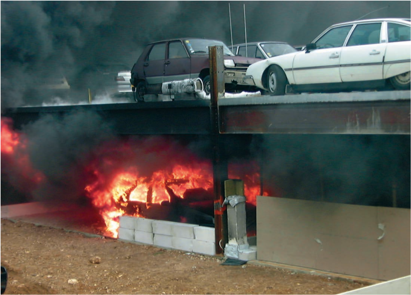
7. Bij een open parkeergarage en Fire Safety Engineering met autobrandscenario is het vaak mogelijk verzinkt staal zonder of met beperkte overdimensionering (en zonder brandwerende bescherming) toe te passen.
