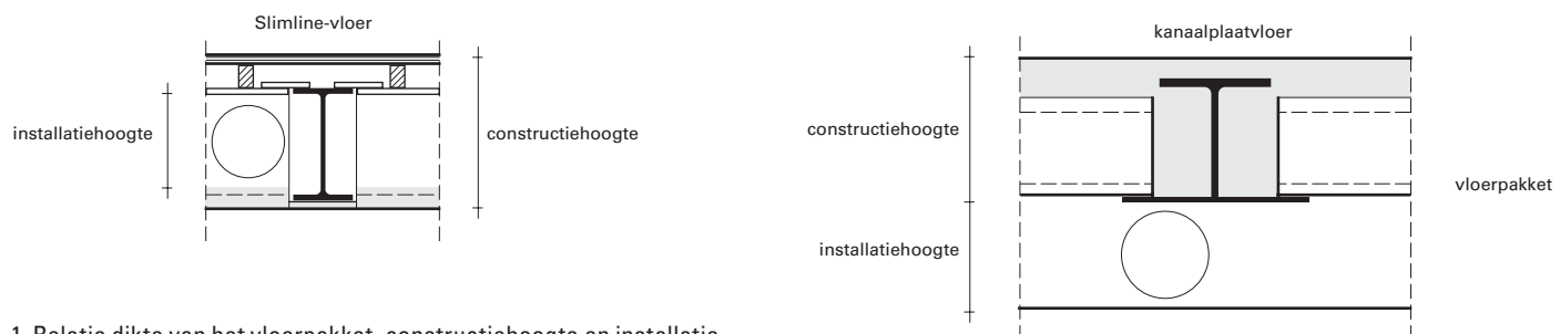
1. Relatie dikte van het vloerpakket, constructiehoogte en installatiehoogte, tussen een geïntegreerde en niet-geïntegreerde vloer.
