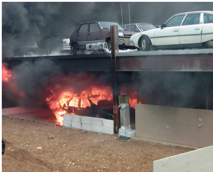
Afb. 1 Tijdens branden in parkeergarages blijkt het temperatuurverloop aanzienlijk af te wijken van de zogenaamde 'standaardbrand' (aanvankelijk iets hogere temperaturen, maar na verloop van tijd lagere temperaturen).
