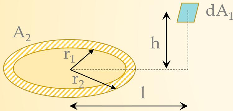
$$F_{dA_1 \rightarrow A_2} = \frac{H}{2} \left( \frac{H^2 + R_2^2 + 1}{\sqrt{(H^2 + R_2^2 + 1)^2 - 4R_2^2}} - \frac{H^2 + R_1^2 + 1}{\sqrt{(H^2 + R_1^2 + 1)^2 - 4R_1^2}} \right)$$
