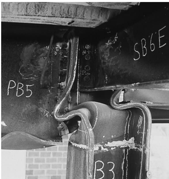
8. Plastische vervorming van het onbeschermd deel van kolom B3 na de raamwerkproef.
