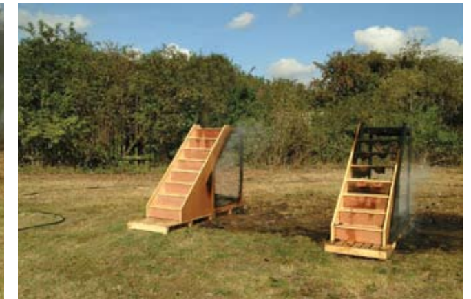
Trap langer beloopbaar bij brand door behandeling brandwerend impregneermiddel
